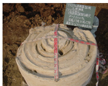
掘起し先端部
